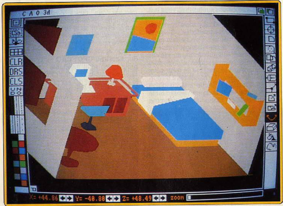
CAO 3D Amiga : couleurs + faces cachées + perspective, la caméra rentre par la fenêtre.
